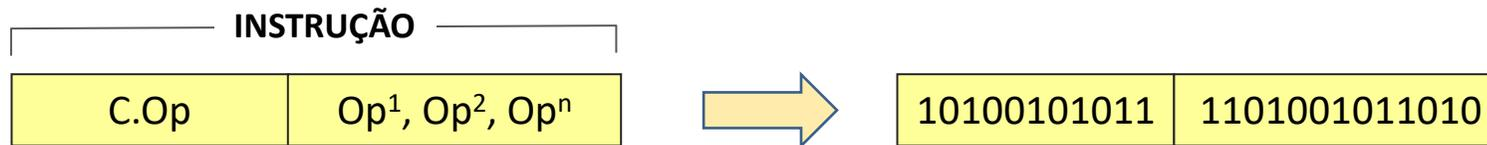
**C.Op - Código de Operação** - É o campo que contém a identificação da operação a ser executada. Cada operação possui um código identificador único. O tamanho, em bits, deste campo determina o número de instruções que o processador pode executar.
